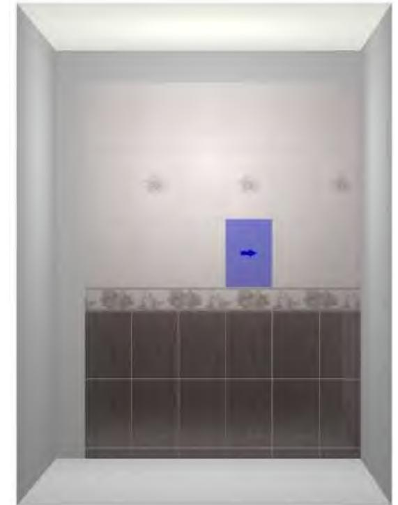
«**Удаление всех плиток на плоскости**» – нажатие на пиктограмму
