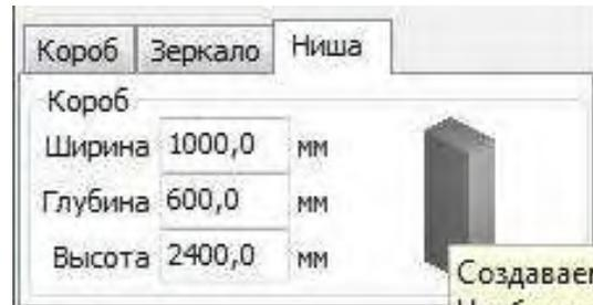
Чтобы создать нишу, нажмите на вкладку «**Ниша**» в Панели инструментов. Укажите нужные вам размеры ниши (ширину, глубину, высоту).
